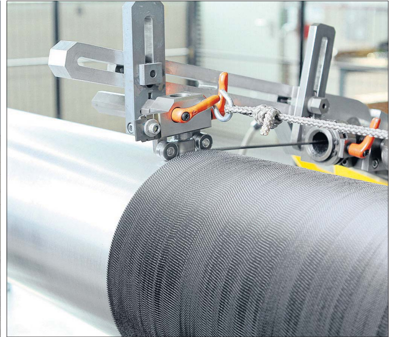
Groz-Beckert zieht Jahresbilanz: 2015 wurde der Logistikhof (links) eingeweiht. Eine Akquisition ermöglicht den Einstieg in die Cardingsparte. Rechts: Die Stahlgarnitur einer Cardingmaschine.
